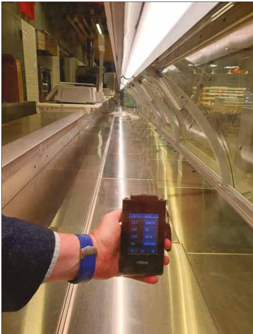
Рис. 4. Уровень освещения внутри витрины более 3000 лк
